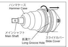
2 アジャストボルトが長溝穴から見え るようにメインシャフトを指で回し ます。
