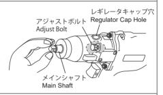
3 アジャストボルトをピンで回し(アジャストロッドの場合はスパナで回し)、トルクを設定します。メインシャフトを前方にした状態で、左に回せばトルクは高く、右に回せば低くなります。
