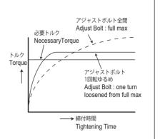
5 スライドカバーを元の位置にもどしてください。トルクの設定の際はテスト 締めの時点でもスライドカバーをもどしてください。スライドカバーの有無によりトルクが変わります。
