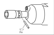
3 ピンの抜け止めのためOリングを 取付けてください。
