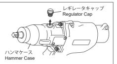
2 アジャストボルトまたはアジャストロッドがレギレータキャップ穴から見えるように、メインシャフトを指で回します。
