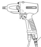
タッチジョイントの締付トルク 13 ± 2 N·m Tightening torque of touch joint : 13 ± 2 N·m
