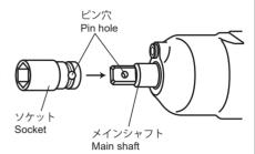
**2** ピン穴にピンを挿入します。 Insert a pin to the pin hole.
