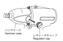
アジャストボルトがレギレータキャップ穴から見えるように、メインシャフトを指で回します。 Turn the main shaft manually to see the adjust bolt through the regulator cap hole.
