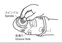
3 アジャストボルトの穴にピンを差し込みアジャストボルトを回すことによって、トルクを設定します。右に回せばトルクは高く、左に回せば低くなります。
