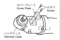
2 アジャストボルトが長溝穴から見 えるようにスピンドルを指で回し ます。
