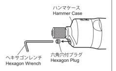
2 トルク調整ネジ又はトルク調整用 丸穴がプラグ穴から見えるように メインシャフトを指で回します。 Turn the main shaft with fingers so that the torque adjustment screw or the round hole for the adjustment screw can be seen from the plug
