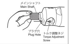
3 トルク調整ネジ又はトルク調整用丸穴をヘキサゴンレンチで回し、トルクを設定します。右に回せばトルクは高く、左に回せば低くなります。
