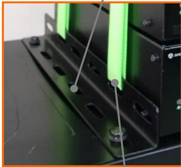
L型アングルの長穴に結束ベルトを通して二重にして、ドライバ、コントローラの外周を囲う。
