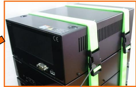
ドライバおよびコントローラを確実に固定する。
