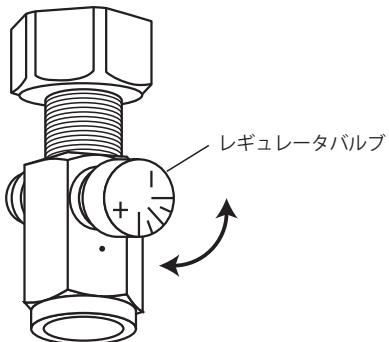
レギュレータバルブを回し、トルクを調整してください。
