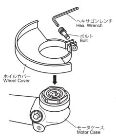
・ホイルカバーをモータケースに挿入して、ヘキサゴンレンチでしっかりとボルトをしめつけてください。
