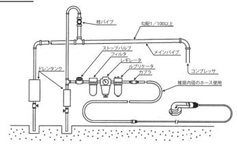
配管は清浄で乾燥した圧縮空気を送るよう実施しなければなりませんので、いかにコンプレッサーを合理的に設置しても配管に注意を怠りますと圧力降下、ドレンなどの悪影響により、出力の低下、および工具の早期破損を生ずる原因となりますので十分にご注意ください。
