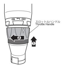
始動は、スロットルハンドルをモータケース側(矢印①)に押し、左方向に(矢印② OFF→ON)に徐々に回してください。 モータケースの後に表示があります。
